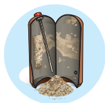
Korozja i kamień kotłowy
