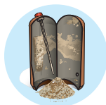
Korozja i kamień kotłowy
